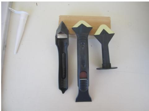
Lisser avec un outil adapté permettant d'avoir un arrondi régulier concourant ainsi à une parfaite étanchéité ...
